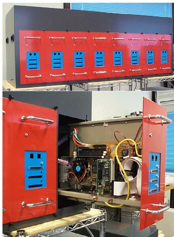
グラフィックカード、キーボードを排除し、ストレージデバイスを別筐体とした非常にシンプルな構造。ラック内は部品点数が少ないので故障の可能性が低くなっています。
